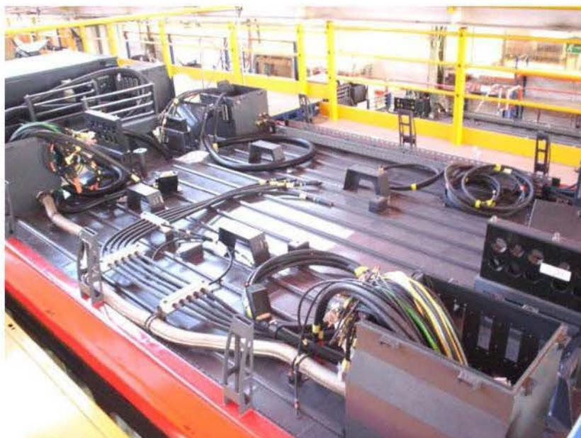
C-2 Roof wiring
