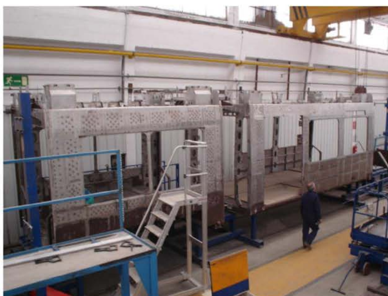
4 Cajas C-1 y D-1 en posición de medida / Bodyshells C-1 and D-1 measuring
