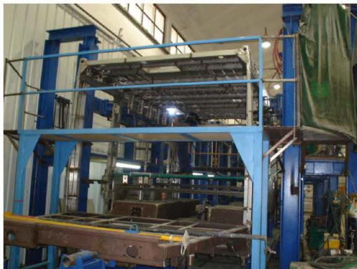
1.- Armado de caja E-1 / E-1 Bodyshell assembly
